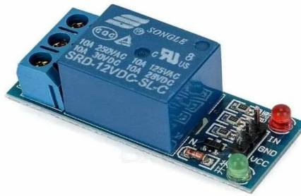
3.6 - сурет – Бір арналы реле
